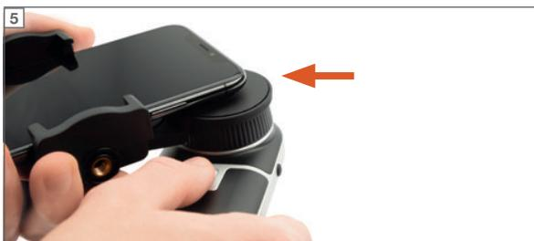
L'aimant de l'adaptateur maintient maintenant le smartphone sur la bague de mise au point du dermatoscope.
