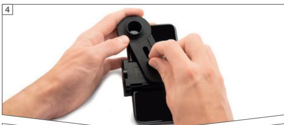
Positionnez ensuite l'adaptateur devant la caméra du smartphone : Pour ce faire, desserrez la vis de type Garrett de l'adaptateur jusqu'à ce qu'il puisse pivoter latéralement et se déplacer d'avant en arrière sans difficulté.
