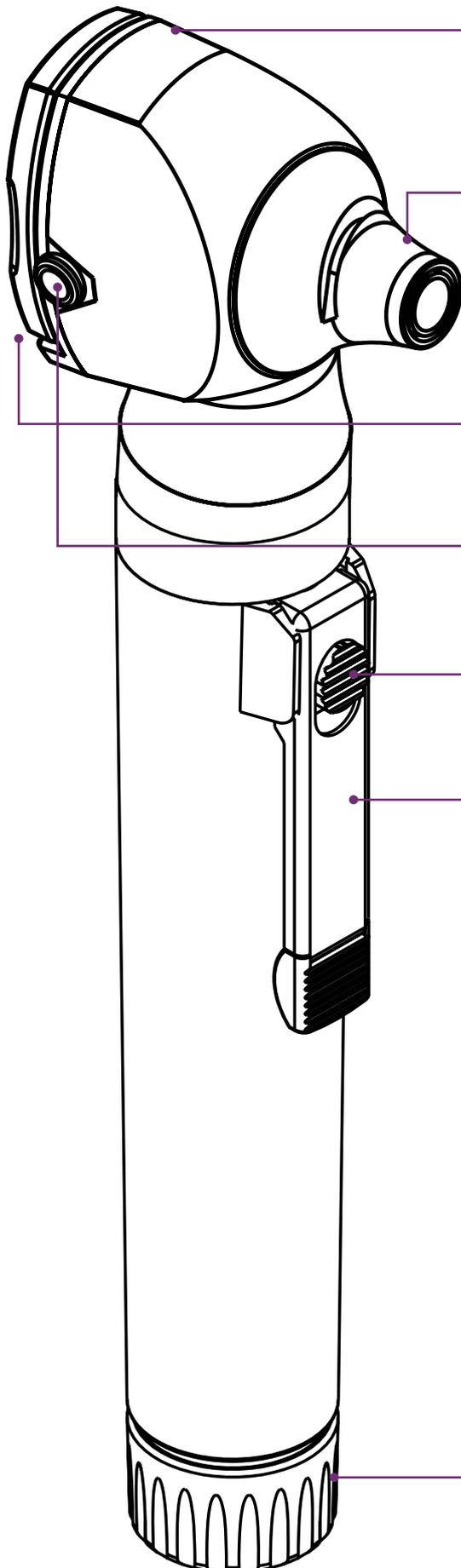
Tête : bimatière (en ABS et Inox), tête vissée pour une fixation sûre.
